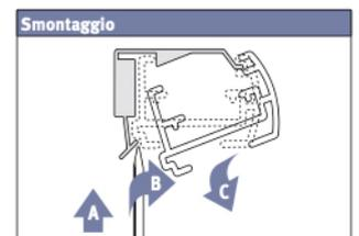
**!** \* Non sollevare la guida inferiore più in alto del binario centrale per evitare di formare un cappio dove ci si possa strangolare.
