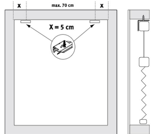
La guida superiore non deve essere installata a una distanza inferiore a 1,50 m dal pavimento. Gli avvolgicavi devono essere installati il più vicino possibile al binario superiore – in ogni caso a più di 1,50 m di distanza dal pavimento.
