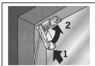
**Fase 5.** applicare il coperchio con alette, ad incastro con filo guida premontato a destra e a sinistra della parte superiore come mostrato in figura.
