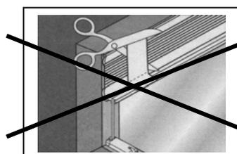
**ATTENZIONE!** Il nastro di protezione giallo NON DEVE ESSERE RIMOSSO prima di aver completato l'installazione della tenda!
