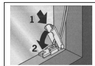
**Fase 7.** Alla stessa maniera applicare il coperchio senza alette, ad incastro con filo guida premontato a destra e a sinistra della parte inferiore come mostrato in figura, facendo attenzione a tenere i fili ben tesi e non arrotolati, posizionando e sorreggendo la tenda a non più di 30cm dalla base.
