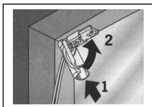
**Fase 6.** Applicare il coperchio con alette, ad incastro con filo guida premontato a destra e a sinistra della parte superiore come mostrato in figura.
