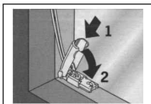
**Fase 8.** Alla stessa maniera applicare il coperchio senza alette, ad incastro con filo guida premontato a destra e a sinistra della parte inferiore come mostrato in figura, facendo attenzione a tenere i fili ben tesi e non arrotolati
