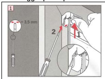
**Fase 1.** Rimuovere delicatamente, con l'aiuto di un giravite piatto, i supporti ad incastro con filo guida premontato premendo prima il supporto delicatamente verso l'alto (e verso il basso per i supporti inferiori).
