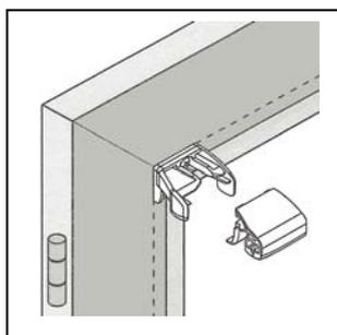
**Fase 4.** Applicare i supporti ad incastro con filo guida premontato ai quattro angoli a destra e sinistra prima alla parte superiore poi alla parte inferiore, facendo attenzione a tenere i fili ben tesi e non arrotolati, posizionando e sorreggendo la tenda a non più di 30cm dalla base.
