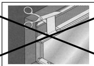
**ATTENZIONE!** Il nastro di protezione giallo NON DEVE ESSERE RIMOSSO prima di aver completato l'installazione della tenda!
